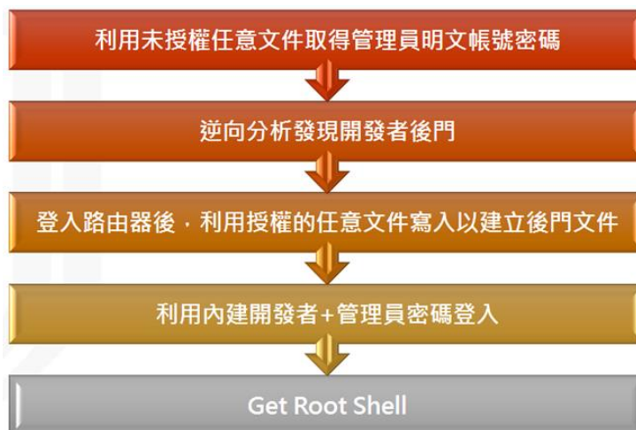
圖 8 駭客利用 MikroTik 路由器漏洞之攻擊手法
