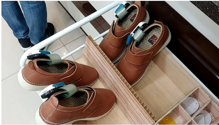
圖 6 穿上內含 178 個感測點鞋墊的專用鞋，正常走 6 步便可得知步態
