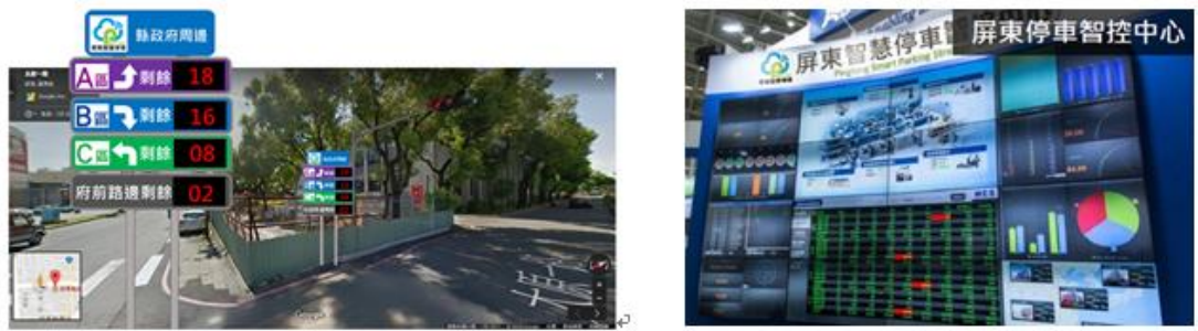
圖 3 服務流程—以「地磁」掌握車位狀況進行引導，於後端分析營運
