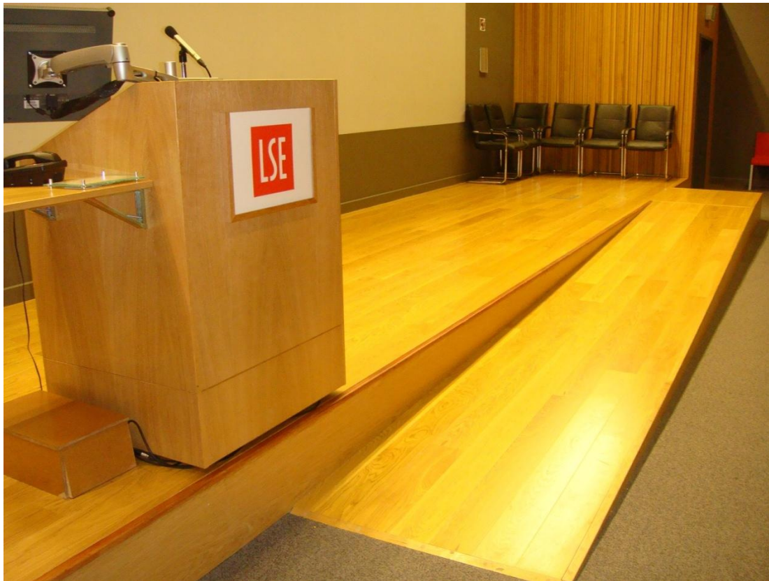
英國倫敦政治經濟學院(LSE)NAB 禮堂斜坡式（無障礙）舞台設計
