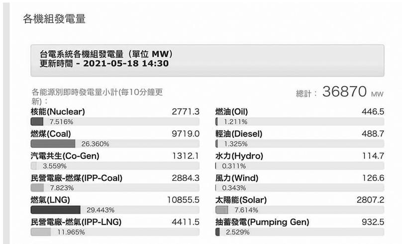
圖 8 2021 年 5 月 18 日台電各能源發電量
